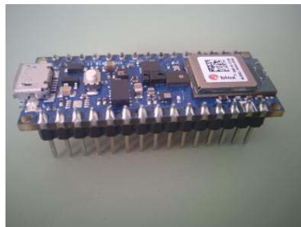
Εικόνα 2. Η διάταξη του μετρητή θερμοκρασίας με βάση το Arduino Nano BLE
