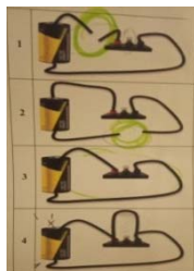
Εικόνα 2: Απεικόνιση μπαταριών συνδεδεμένων με λαμπτήρες (σύνθετο κύκλωμα).
